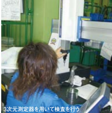
3次元測定器を用いて検査を行う
