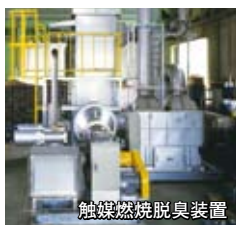
触媒燃焼脱臭装置
