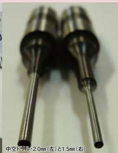
中空ドリルによる15mmの積載した紙に2.0mmと1.5mmの穿孔見本
