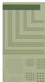
ファインライン用ペースト印刷例
