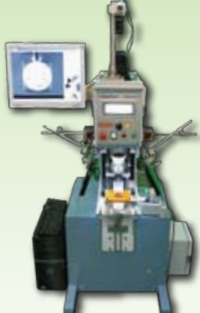
パッド印刷機に搭載する検査装置 NCL-PAD
