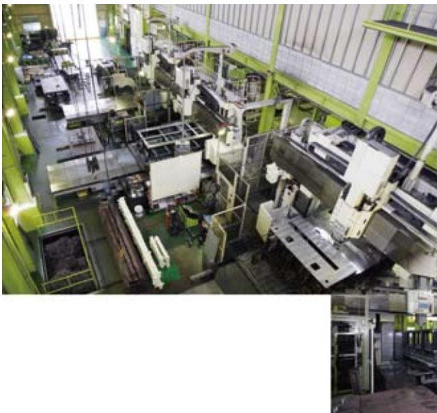
大型の『門形五面加工機』。3m×6.5m-1台、2.5m×5m-1台、2.5m×4m-1台を所有する
