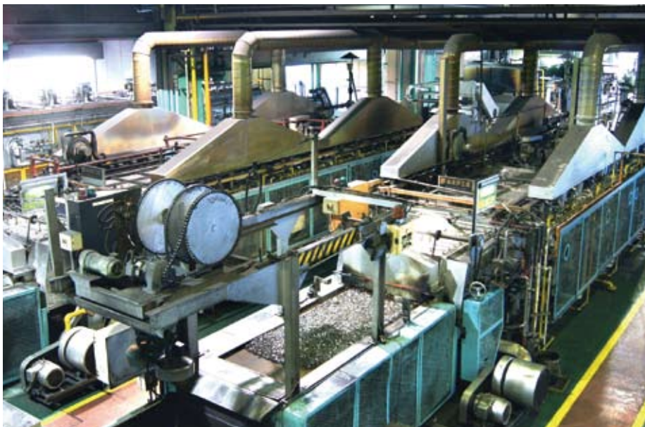
大型連続焼入焼戻炉は、大量生産品の小物部品から特殊大型部品に至るまで対応している
