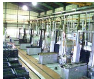
温度、保持時間等すべての熱処理条件がプログラム管理されているバッチ型浸炭炉ライン
