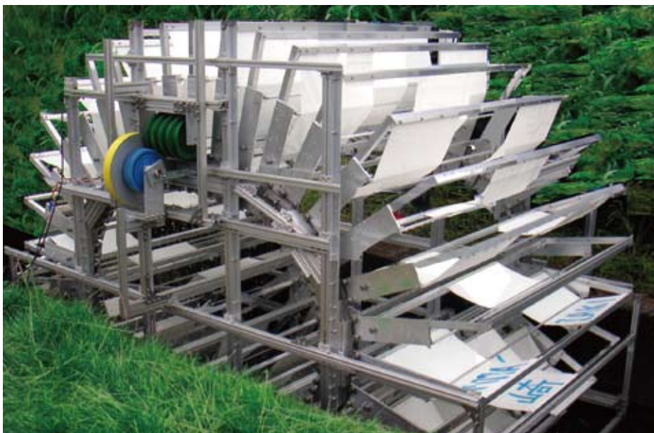
縦、横どちらにも設置可能な楕円形水車を用いた「流水利用式マイクロ水力発電システム」
