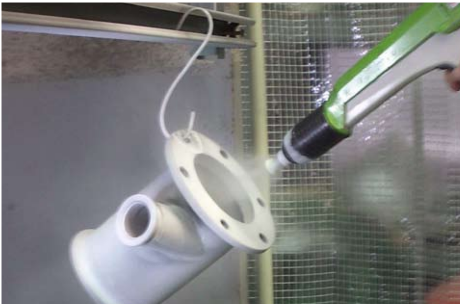
一般的な静電粉体塗装でのコーティング風景
