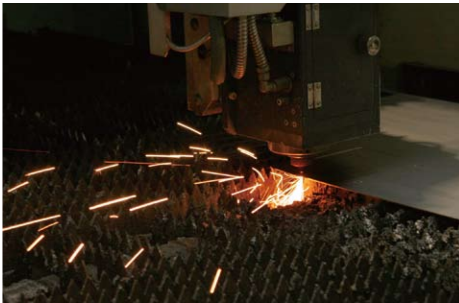
ステンレス素材はレーザーでカット。精密さが要求される作業は熟練の職人が丁寧に施す
