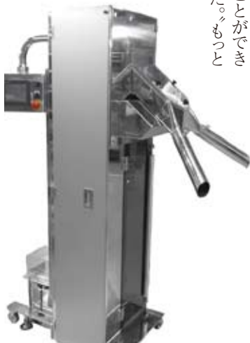
製薬工場で使用されるバケットリフト。 特許申請中の新技術が搭載されている
