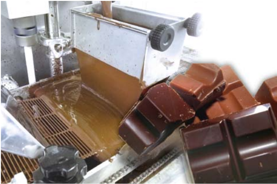
粘度の高いチョコレートの、均一化されたカーテンが美しいコーティングを生みだす
