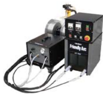
これからの飛躍の一翼を担う、現在開発中の「ポータブル式アーク溶射機」
