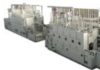
最近出荷した大型最終洗浄機。2台は姉妹機で、共に全長12m、高さ4.5mでステーションを持つ
