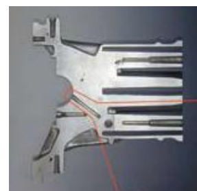
冷却効果（赤線内）できれいに仕上げられたシリンダー断面
