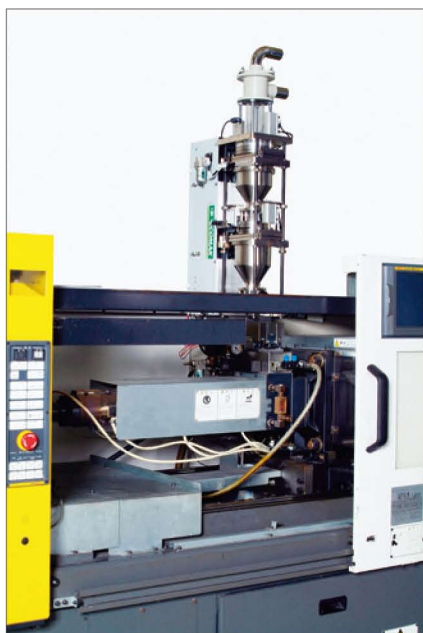
「エコマック」本体（エコ・ホッパーユニット）（右）と、「エコマック」を装着したプラスチック成形機（左）
