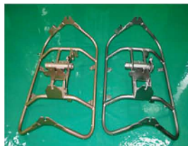
電動アシスト付三輪自転車用フレームの試作品（左：鉄・右：マグネシウム合金）
