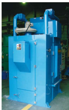
塗装ハンガー剥離用途の標準型ハンガー式プラスト装置
