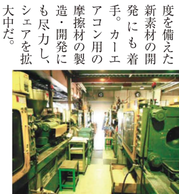
熱硬化性用成形機等の設備
