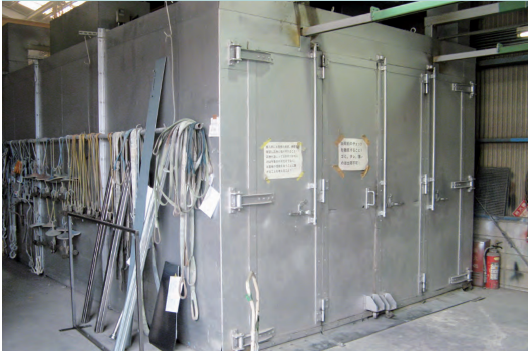
大型の品物を焼き付け塗装できる立窯（たてがま）乾燥炉
