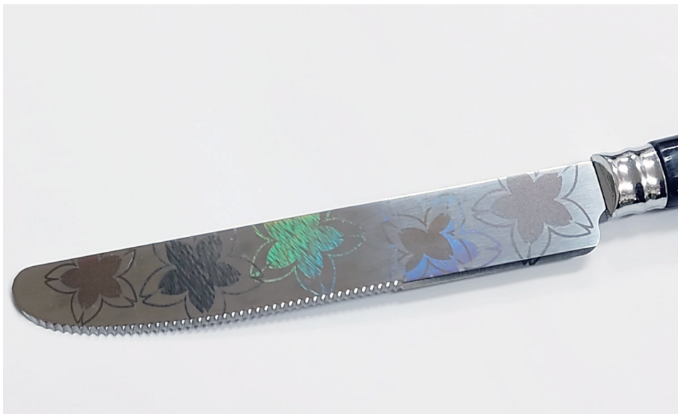
レーザーマーキングにより金属製品を発色できる
