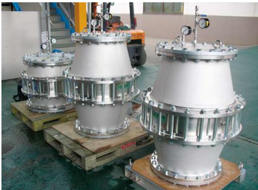
タンカー等に搭載される海水処理装置
