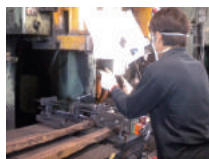
ワンタッチ着脱の金型交換
