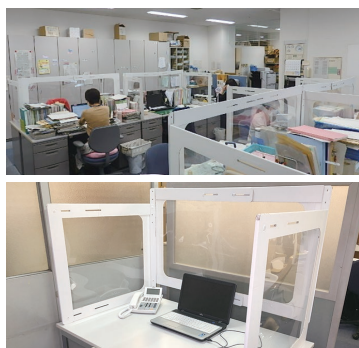
ダンボールでつくられた、飛沫感染対策のデスク用スライド式ボード。近畿大学の図書館や東大阪市保健所でも使用されている ●株式会社マツダ紙工業
