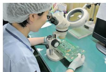
ミリ単位の作業も多いため、検査工程も重要になる。「チャレンジ0ppm」(初期不良率ゼロ)をスローガンに、独自の管理体制で品質管理の徹底を図っている
