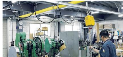
電動ウインチなど100kgまでの荷重に耐える新製品の「キャリアレール」。分岐ユニットで走行ルートの切り替えも可能
