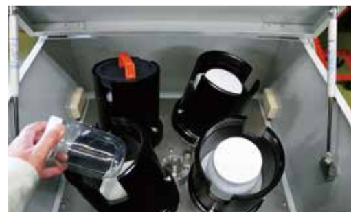
「SANMIX」の内部。アダプターによって任意の容器が装着可能。常に新しい保管容器が使用できるためコンタミネーションが皆無に
