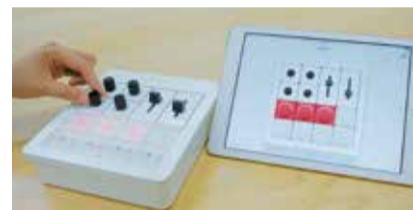
モジュールを組み替えて自分オリジナルのMIDIコントローラにできる「MINE」。制御系、アプリ開発、BLE（通信技術）等、同社の技術が詰まった集大成的製品だ
