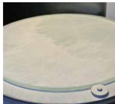
ガラス製ディスクなので研磨面の平滑度を保つことができ、断面の観察がしやすくなる。ガラス製の研磨台を製作しているのは国内では同社のみ
