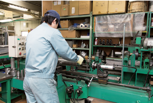
三元ラセン管工業のペローズは、内側から圧力をかけて1回で成型する量産品と違い、外側から7回に分けて圧力をかけて成型していくため、金属に無理な負荷がかからず、耐久性や精度も高まる。恐ろしく手間がかかる製造法だが、そうして生まれる製品は量産品にはない優れた特性を持つ
