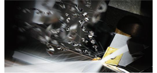
外部からでなくドリルの先端からクーラントを出し、切りくずを加工した穴から排出。インバータにより必要吐出量に合わせて流量を最適化し、もっとも効率の良い加工条件を得ることができる
