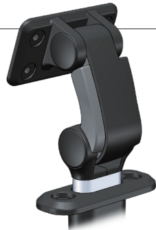
ボタン操作により簡単に角度調整を行うことができる角度調整パーツ「Tロックギア」はガタつきなく、強固にロックさせることが可能。こちらは2軸のロックを同時解除でき、簡単に位置調整ができる「ヘッドレスト2軸タイプ」。
