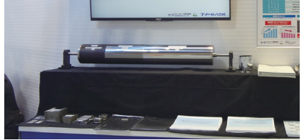
カーボンファイバー（CFRP）ロールへの超硬質三価クロムめっきの開発に成功。CFRPの表面に鉄めっきを施し、クロムめっきやニッケルめっきを施すことで耐腐食性に優れた、究極の軽量化ロールの生産が可能に
