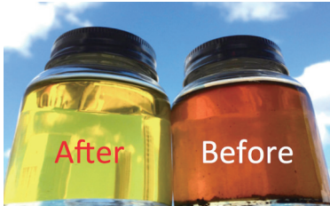
調理後の汚れた油に食品添加物である吸着剤を入れ、特殊なフィルターで油を濾過すると、調理後の油に発生する身体に有害な物質（遊離脂肪酸など）が吸着・除去され、色目・臭い・酸化など油の品質が回復する
