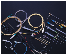
自社の押出成形でつくられた、医療用カテーテルチューブ。硬度が違う3種類の樹脂を一連の成形でコーティング、冷却、切断、巻取りまでの工程をおこなうことができる
