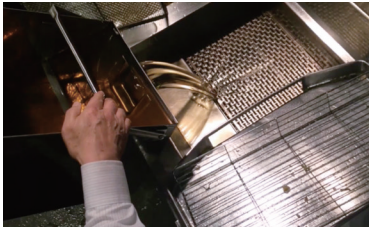
店舗に必要なのは、専用ろ過容器と消耗品の吸着剤とフィルターのみ。女性でも簡単に作業でき、油の品質を回復させ、使用量も大幅に削減できる
