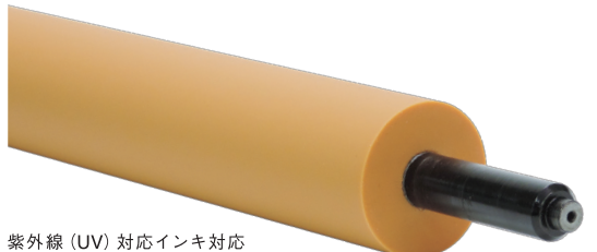
紫外線（UV）対応インキ対応ロール「トラスト・ZETA（ゼータ）」は、UVを照射することで硬化乾燥する高感度UVインキやパッケージ印刷用インキに適した製品。ロール洗浄が早くすみ、膨張しないという特性を持つ。印刷物に悪影響を及ぼす物質は使用されておらず、食品や医療関係、海外向け製品などに安心して使用できる
