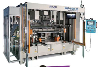
3次元曲面への表面加飾が可能なマシンNGF-0512-RS。材質を問わず大型製品も加飾可能でフィルムに印刷した文字・絵柄合せも容易
