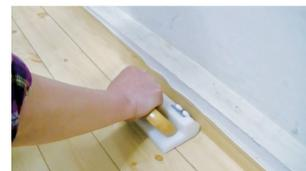
押し当ててスライドさせるだけできれいに切れる、クッションフロアカッター。切断面が上は長く、下は短く斜めに切れるため隙間もできないうぐれもの
