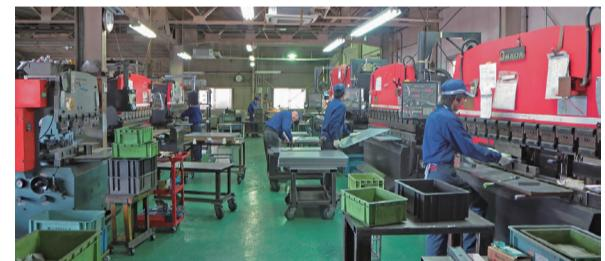
毎朝の3S活動により整理整頓された工場。切断、プレス、溶接など各工程において機器を複数台保有し、数多くの加工を同時に進行でおこなう体制を整えている
