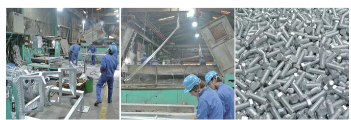
460度の高温で溶かした亜鉛に鋼材を浸し、表面に亜鉛皮膜を形成する溶融亜鉛めっき。社内には国家認定資格である一級めっき技能士が8名在籍。5年前には製造ラインを1台増設し3ラインに拡張。大型品から小型品まで幅広く利用できる設備で、ラインも半自動化して生産コスト低減に成功している
