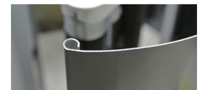
曲げ工程は板金加工でもっとも技術が発揮されるポイント。トレーラでもR形状の反射板の先端をカール曲げにすることで、捕虫紙のホールドを確実にする
