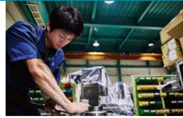
機械では実現できない高精度平面加工を職人の手でおこなう「きさげ技術」（村上精機）
