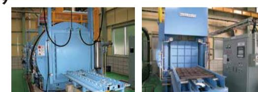
金型の使用条件や使用部位ごとに処理条件やガス組成の検討を詳細におこない、最適化する表面処理方法「KOSUMO-Process」で使われる真空ガス軟窒化炉
