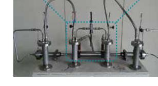
油圧シリンダーの左右往復運動により、外側カートリッジから内側のカートリッジへ水と砥粒が移動し、高圧・高速流動研磨や搅拌研磨の効果が得られる遊離砥粒装置
