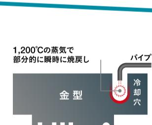
1,200°Cの蒸気で部分的に瞬時に焼戻し
