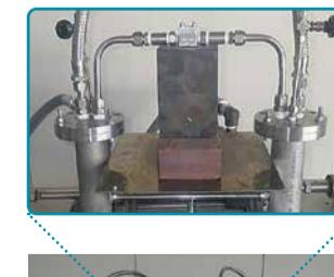
内側のカートリッジに挟まれた配管先端から金型内に砥粒が送り込まれ、往復運動によって接続された金型の冷却穴内を研磨する構造になっている
