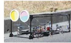
実用化を目指して現在進めているのが、神戸高専の清水准教授との共同研究による、壁面吸着ドローン。トンネル壁面の打音検査などの応用を想定している
