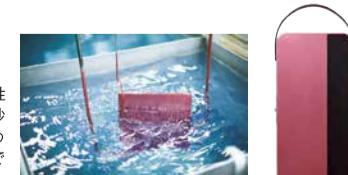
アルミニウムの耐食性、耐摩耗性を向上させるアルマイト染色は、秒単位で濃度が変化する。「漬け染め技術」と呼ばれる高度な職人技で染め上げている
