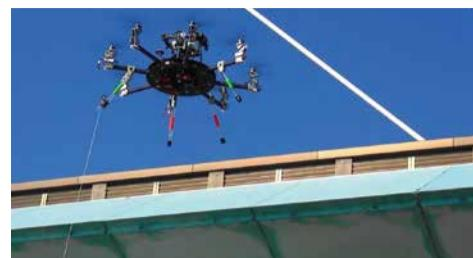
大阪市立大学、徳島大学と共同開発した橋梁点検ドローン。機体上面に撮影機器を設置し、機体やプロペラの写り込みを回避。測量データと照合し、ひび割れやさびの位置を記録
