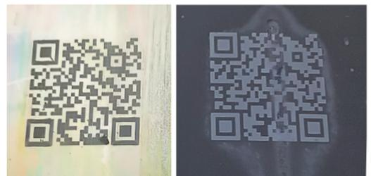
透明1μmの被膜、耐熱1000℃で金属変色を防止するQRコード認証。部品ごとに付ければ、管理性能も上がる。無機被膜に新たな付加価値を与えた技術だ
