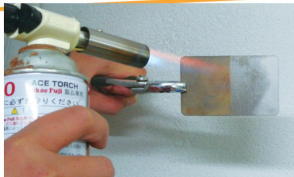
ステンレスに液剤を塗布してバーナーの火であぶる実験。未塗布部分(左)と塗布部分(右)の変化の違いに注目してほしい
