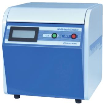
岩石、ゴム、プラスチックから生物体まで分析試料の前処理時間を大幅に短縮するマルチピースショッカー®PM2000。地球深部探査船「ちきゅう」にも搭載。立体8の字運動の原理によって試料を秒速で精密に均質粉碎する。最大196個まで同時に粉碎可能なモデルもある
