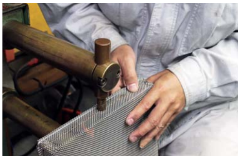
金網カゴのスポット溶接風景
