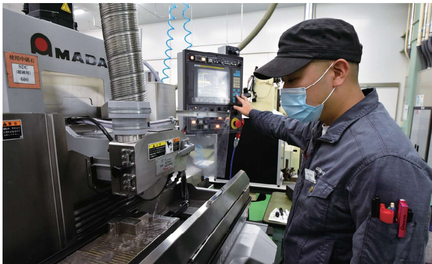
金型部品の研磨の様子
