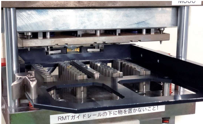
端子圧入した基板切断プレス金型
