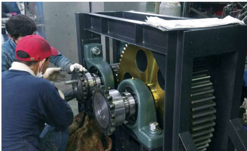
架台製作（組入作業）
