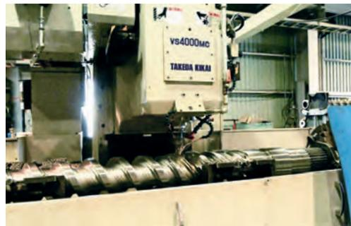
4軸同時制御の螺旋加工が行える
