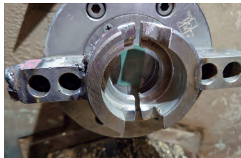
独自開発の2方爪と治具の例
