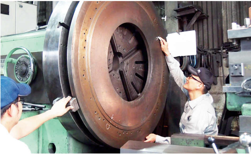
自動刃物送り機構付き正面旋盤で高難度の加工に対応
