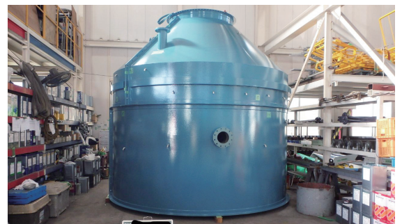
洗浄塔最上部完成品
