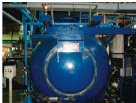
同社保有の真空焼入れ焼戻し炉
