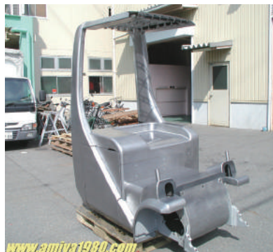
叩き板金の技術を用いて製作したフォークリフトのボディ
