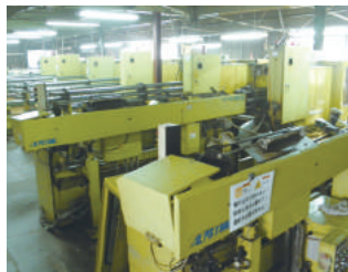
棒材を効率的に切削加工する6軸自動旋盤
