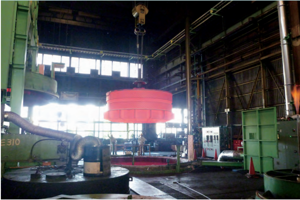
最大直径4mの浸炭焼入れ処理に対応
