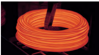
コイル材を巻いたまま熱処理
